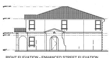
**RIGHT ELEVATION - ENHANCED STREET ELEVATION** 2 STORY SCALE = 1/8"=1'-0"
